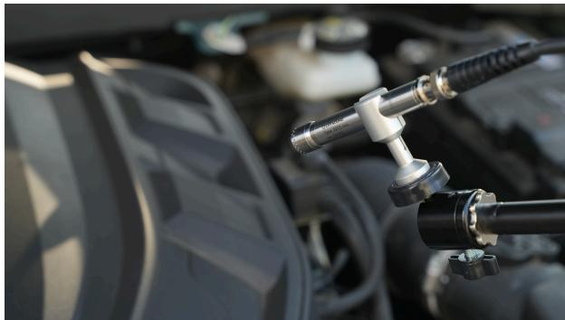
在某汽车厂动力总成降噪测试项目中，CRY3213 NVH 传声器被部署于发动机舱测试点，依托宽温域设计，在高温工况下实现稳定的数据采集。
