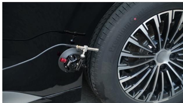
在某主机厂道路测试中，CRY3213部署于轮罩等测点，IP67防护等级有效抵御车辆行驶过程中溅起的水和泥沙侵入，确保复杂路况下稳定采集行驶噪声数据。
